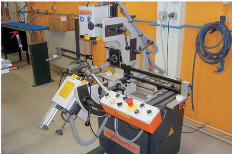
Stroj za izradu poluolive i olive
