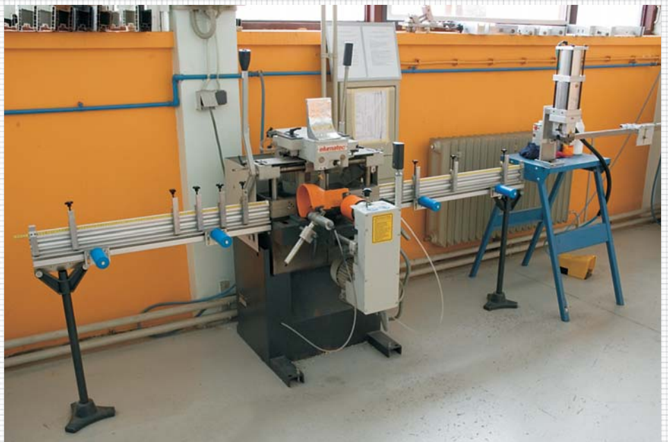
Stroj za izradu poluolive i olive
