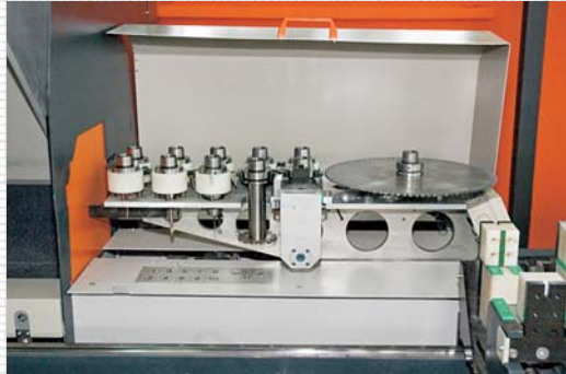
Set alata kojima se obrađuju alumijski profili
